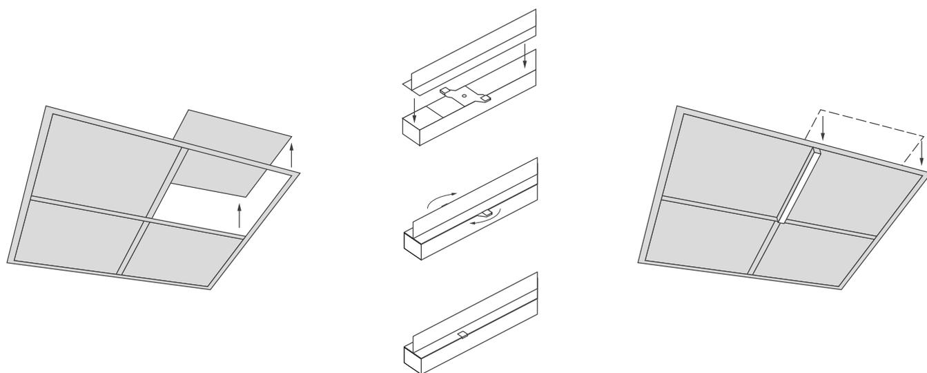
Рис. 1. Установка светильника
