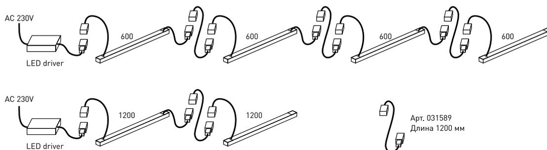
Рис. 2. Способы линейного подключения светильников
