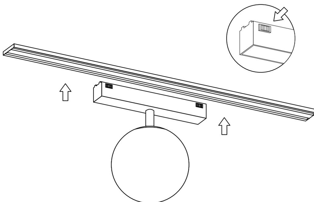
Рис. 2. Установка светильника
