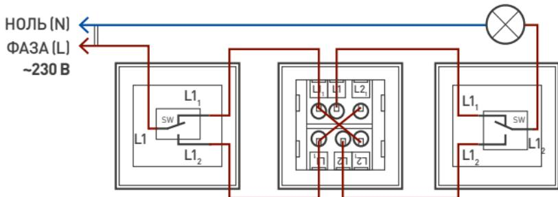
Рис. 1. Схема подключения
