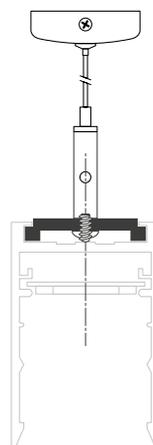
Рис. 1. Установка заглушек для системы MAG-25
